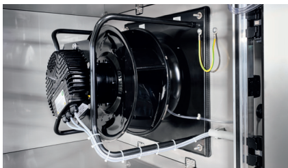
Radialventilator, direktgetrieben, für mittleren Druck, drehzahlregelte EC- oder AC-Motortechnik.
