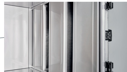
Hygienegeprüfte Schalldämpferkullissen. Gerundete Ein- und Abstromkanten verringern Eigenrauschen und Druckverlust.
