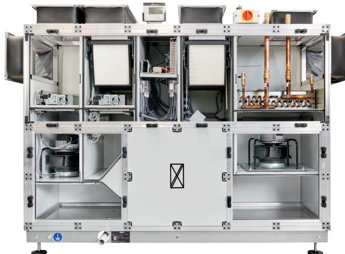
Hochwertige Komponenten, wie beschichteter extra dichter Aluminium-Gegenstromtauscher mit über 84 % Wirkungsgrad, effiziente EC-Ventilatoren und energiesparenden Kompaktfiltern (Effizienzklassen A+) mit Filterspannvorrichtung, Warmwasser-Nachheizregistern, garantieren Energieeffizienz und Nachhaltigkeit.
